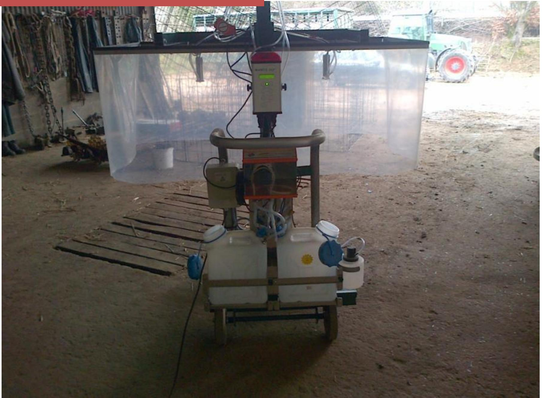
Lorsque la machine est fournie avec son support mobile, la hauteur de traitement peut varier de 0.80 à 1.80 m (hauteur du tapis par rapport au sol.
