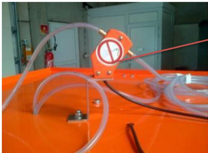
Option « détecteur de fluide » : permet de déclencher l'alarme en cas de bidon vide ou problème d'alimentation en produit
